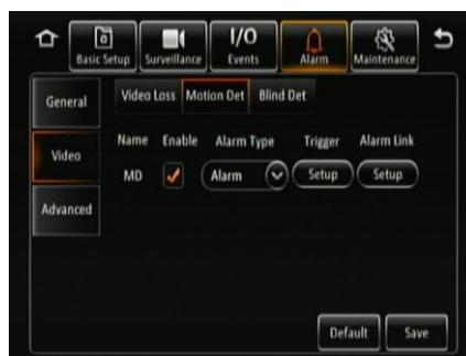
Alarma de detección de movimiento: Figura 88
